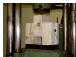
Model spoje – měření zatížení do porušení
